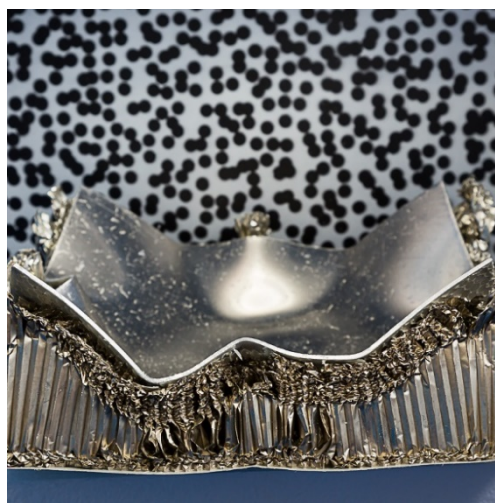
Éprouvette après impact de type "choc à l'oiseau" (photo Patrick Dumas pour IRT Saint Exupéry)
