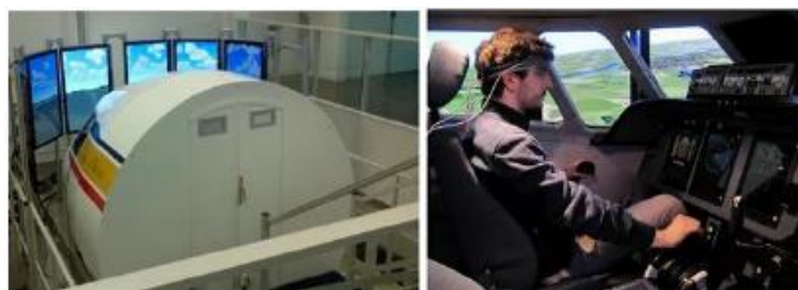
Figure 1 : Le simulateur de vol PEGASE flight simulator, à mi-chemin entre la simulation haut de gamme et la simulation sur ordinateur individuel, est idéal pour la recherche en facteurs humains et sur les assistants de cockpit.
