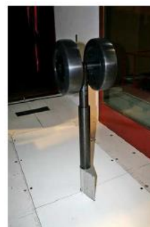
Figure 5 : Atterrisseur simplifié LAGOON à 2 roues dans la soufflerie F2 de l'ONERA [1].
