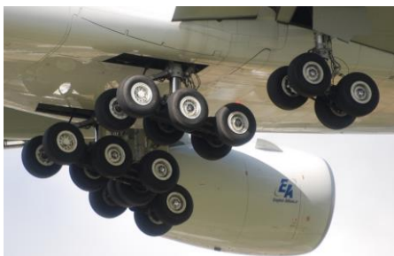
Figure 1 : Atterrisseur principal de l'Airbus A380 (2 x 4 + 2 x 6 roues)
