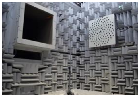
Figure 4 : Antenne de localisation de sources acoustiques de 120 microphones installée dans la soufflerie SAA de l'ISAE-SUPAERO.
