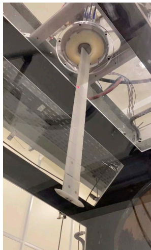
Figure 1 : (gauche) vue d'un prototype d'aile flexible en soufflerie; (droite) aube de soufflante équipée de patchs piézoélectriques.
