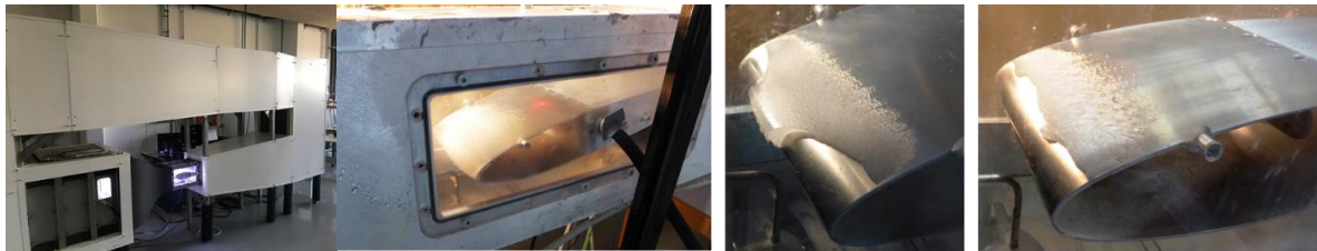
Exemple de dégivrage sur profil NACA en aluminium avec excitation sur une plage de 2 à 10 kHz (tests réalisés par l'ISAE-SUPAERO et l'INSAT/ICA).
