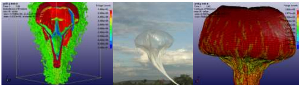
Fig . 1 : Simulation de l'effet champignon de Ballons Stratosphériques Ouverts (Contrat CNES)
