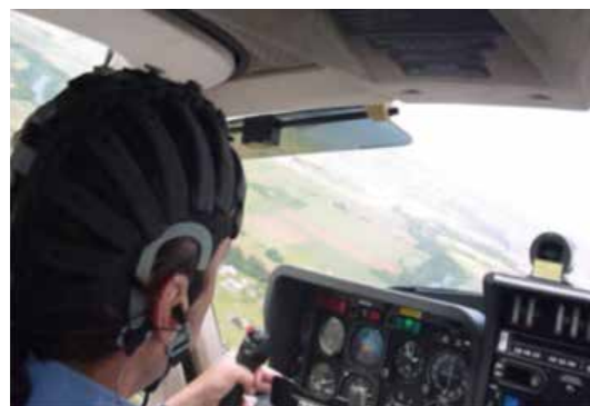
TB20 utilisé pour réaliser des expérimentations en condition réelle de vol (à gauche) – le pilote testé est équipé d'un électro-encéphalogramme pour mesurer son activité cérébrale en vol pilotage (à droite).
