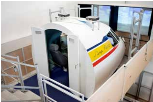
Simulateur de vol 3 axes (à gauche) permettant l'enregistrement de données physiologiques et cérébrales en situation écologique de pilotage (à droite).
