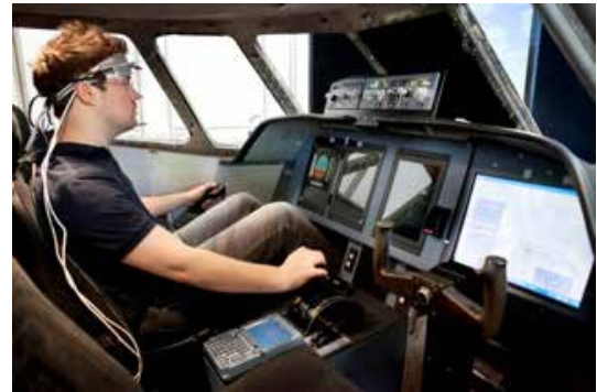
Simulateur de vol 3 axes (à gauche) permettant l'enregistrement de données physiologiques et cérébrales en situation écologique de pilotage (à droite).
