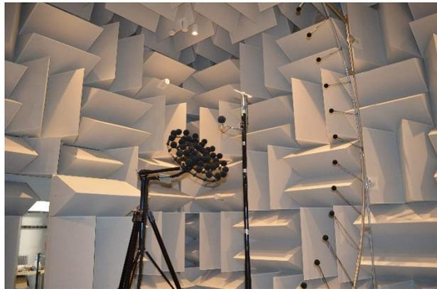
Figure 2: Mesure du bruit rayonné par une hélice de drone dans la chambre anéchoïque de l'ISAE-SUPAERO.
