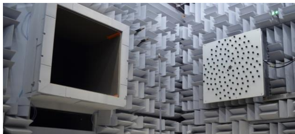
Figure 1 : Antenne de microphones dans la soufflerie aéroacoustique de l'ISAE-SUPAERO.
