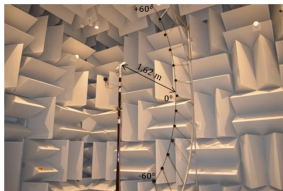
Figure 1 : Mesure du bruit généré par un rotor isolée dans la chambre anéchoïque du DAEP [1]
