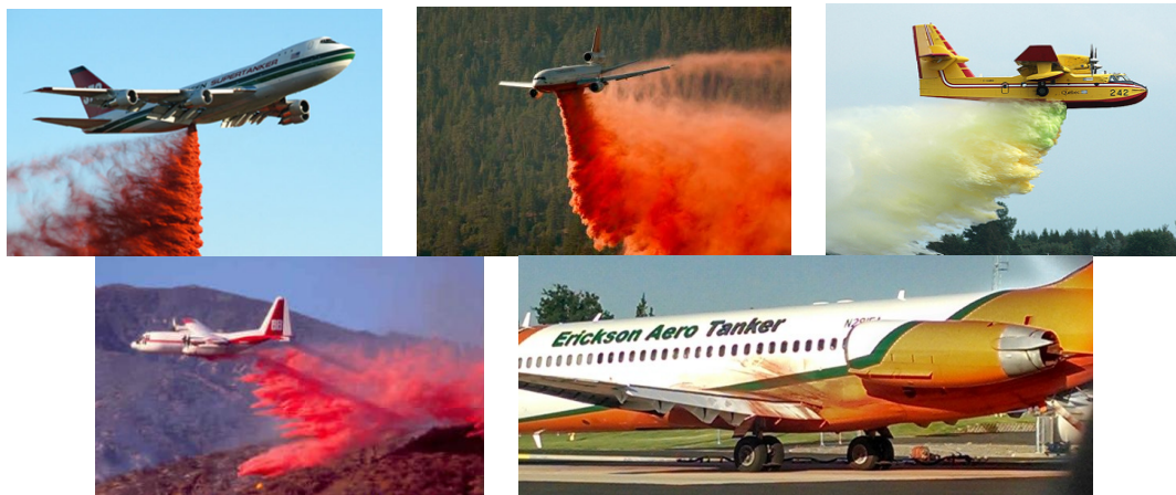
Fig1 : Visualisation de retardant capturé par les tourbillons de sillage. En haut : Boeing 747 (gauche), DC10 (centre), Canadair (droite). Figure du bas : Instabilités en sortie du réservoir (gauche) et recouvrement du fuselage et du réacteur après un largage (droite).
